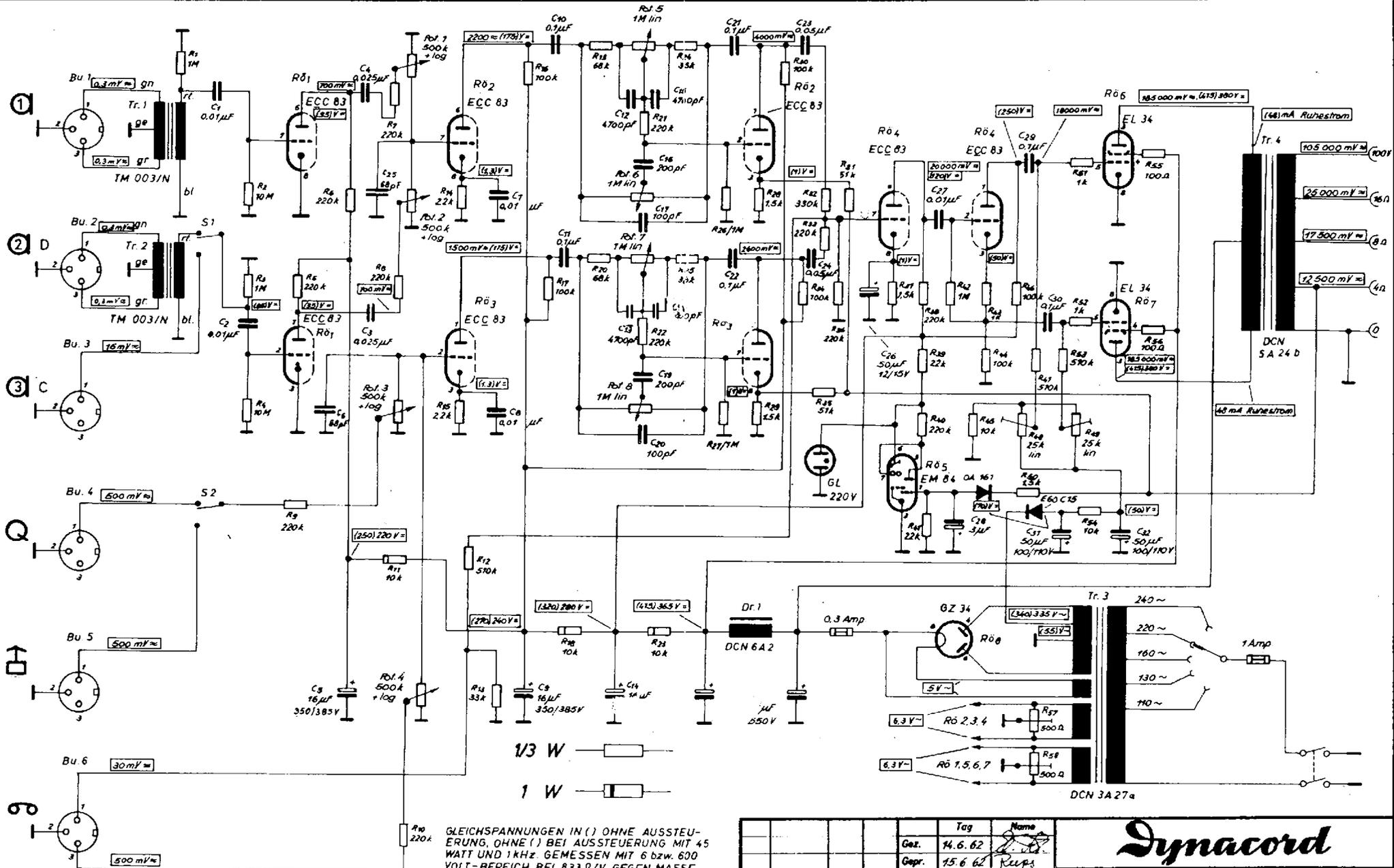
GLEICHSPANNUNGEN IN ( ) OHNE AUSSTEUERUNG, OHNE ( ) BEI AUSSTEUERUNG MIT 45 WATT UND 1KHZ. GEMESSEN MIT 6 BZW. 600 VOLT-BEREICH BEI 833 Ω/V GEGEN MASSE. TONFREQUENZSPANNUNGEN GEMESSEN MIT ROHRENVOLTMETER. R-LAST = 16 OHM
